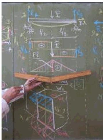
Изгиб и разрушение двухопорной деревянной балки
