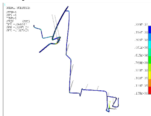
Рис.17. Распределение статических эквивалентных напряжений по Мизесу
