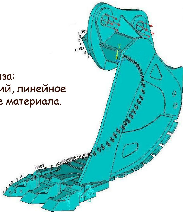
Рис.16. Граничные условия исследуемой модели для 2 случая нагружения
