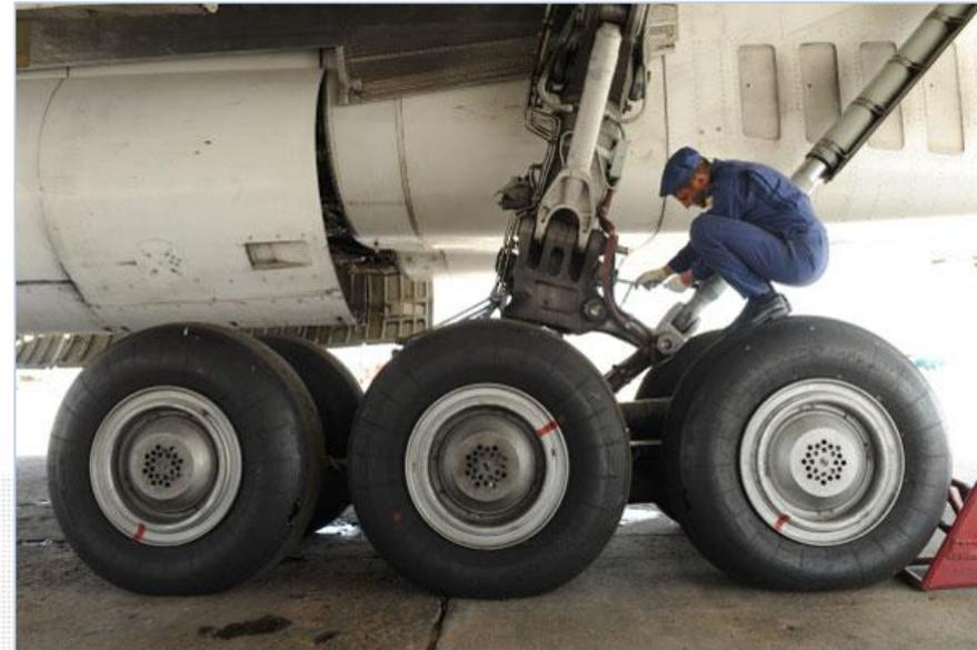
Шасси представляют собой систему опор самолёта, необходимых для стоянки на земле (палубе корабля или воде) и движения самолета при рулёжке, разбеге и пробеге. Масса шасси достигает 4 – 6 % массы самолета.
