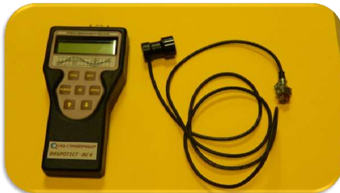
Рис. 10. Прибор для измерения вибрации, частоты и амплитуды «Вибротест МГ-4»
