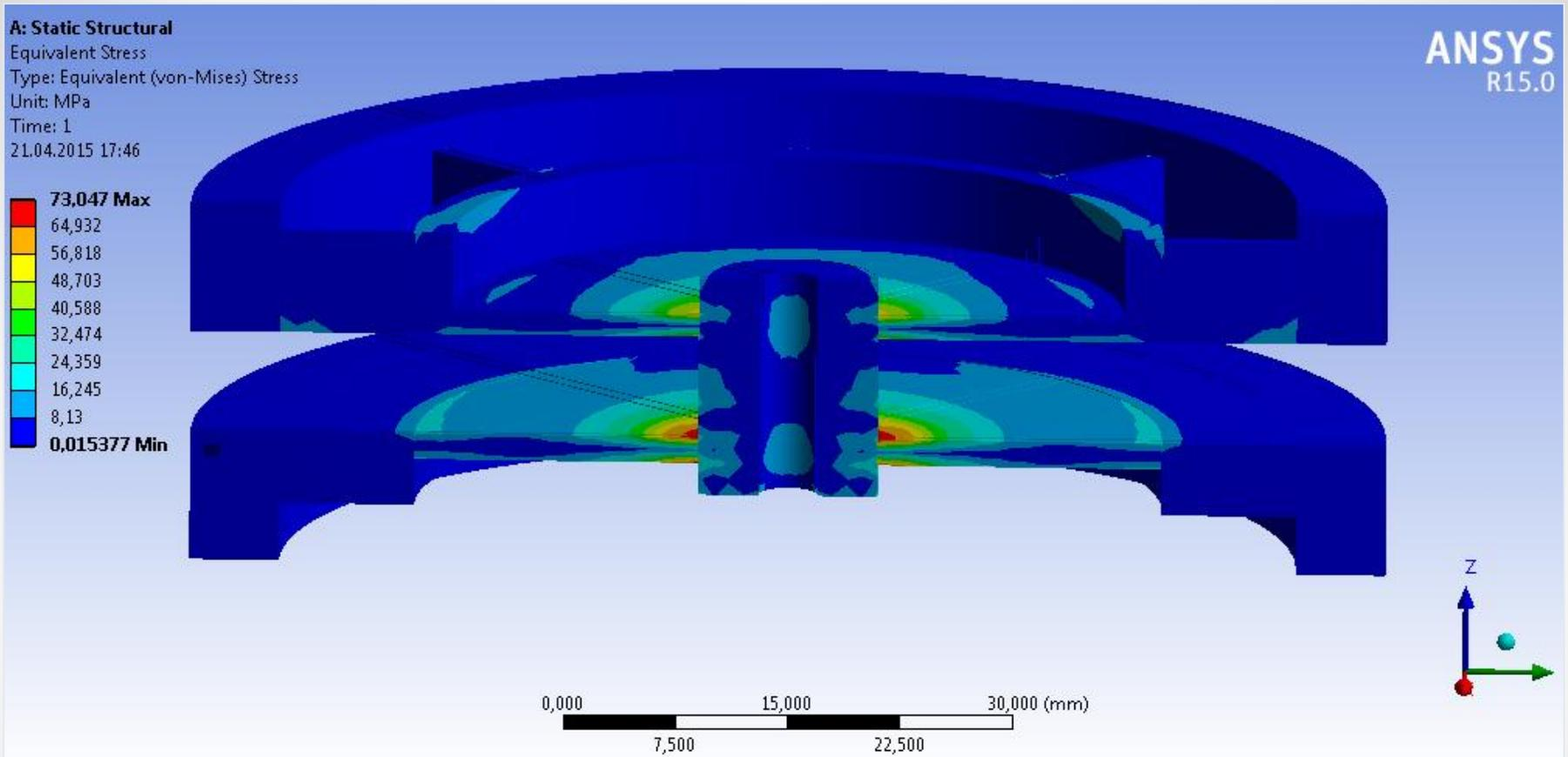
Распределение эквивалентных напряжений при нагрузке верхней части конструкции силой 150 Н по оси Y
