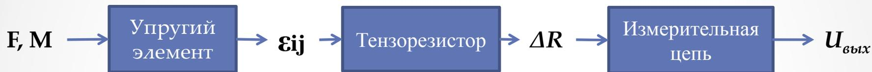
Принцип действия основан на измерении изменения сопротивления тензорезисторов, наклеенных на упругое тело (упругий элемент), которое под действием силы и/или момента деформируется и деформирует размещенные на нем тензорезисторы. Измерительная цепь преобразует изменение сопротивления  $\Delta R$  в выходной электрический сигнал  $U_{\text{вых}}$
