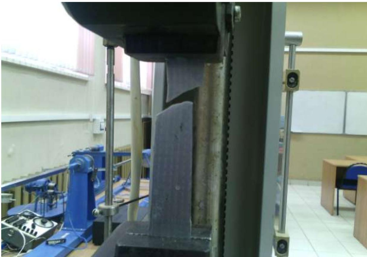
В ходе 2-го эксперимента в разрывную машину Р-5 был помещен перфорированный уголок
