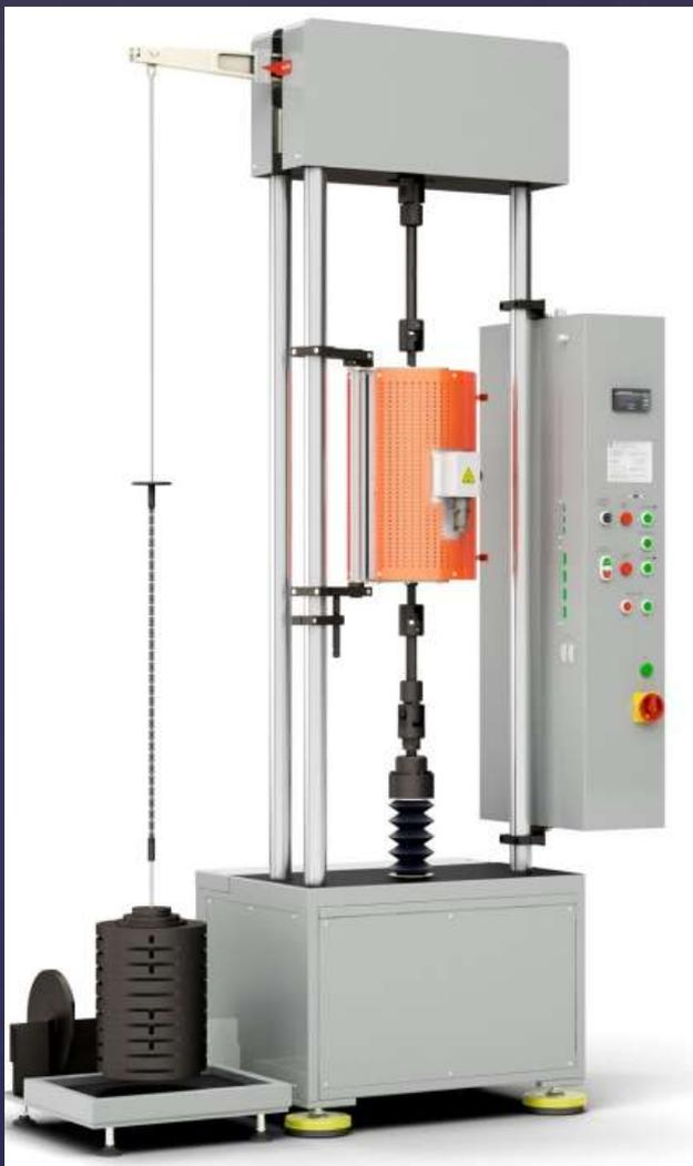
Принцип проведения испытаний на машине УТС1300 основан на приложении к испытываемому образцу нормированного значения силы при постоянном значении заданной температуры.
