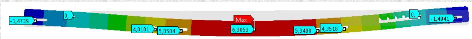
Рис. 16. Перемещения трехмостной траверсы по оси X, мм
