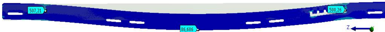
Рис. 27. Эквивалентные напряжения трехместной траверсы, МПа
