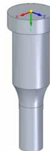
Рис.9. Трехмерная модель пуансона
