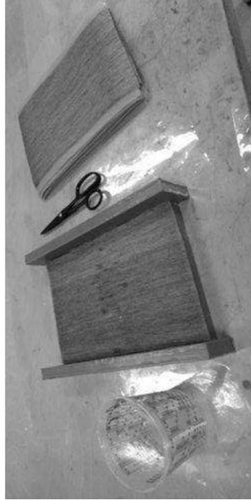
Рис.6 - Вид формы, укладка армирования и матрицы в форму
