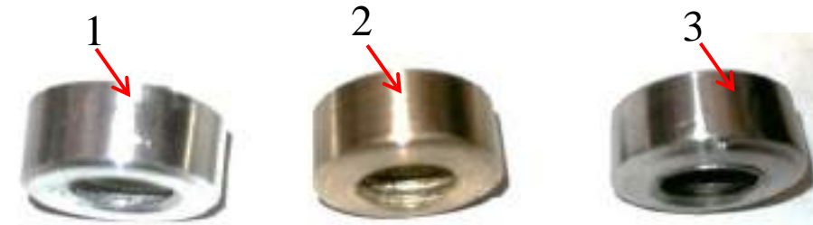
Рис.5. Гайки: 1 – алюминиевая (Д16Т); 2 – нержавеющая сталь (12Х18Н10Т); 3 – бронза железистая (БрАЖ9-4)
