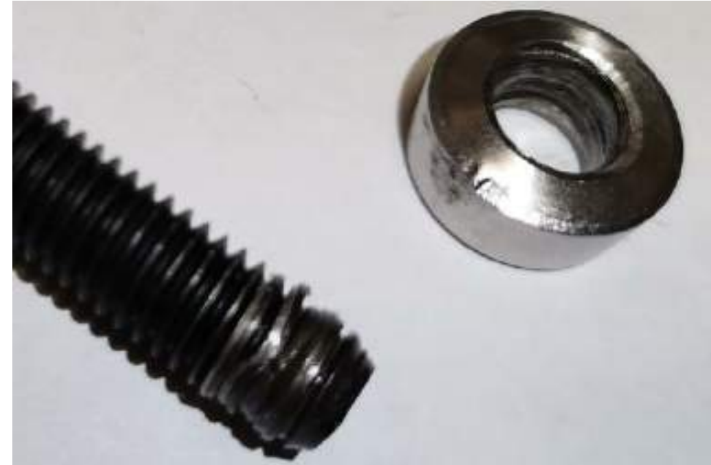
Рис.12. Разрушение гайки из нержавеющей стали
