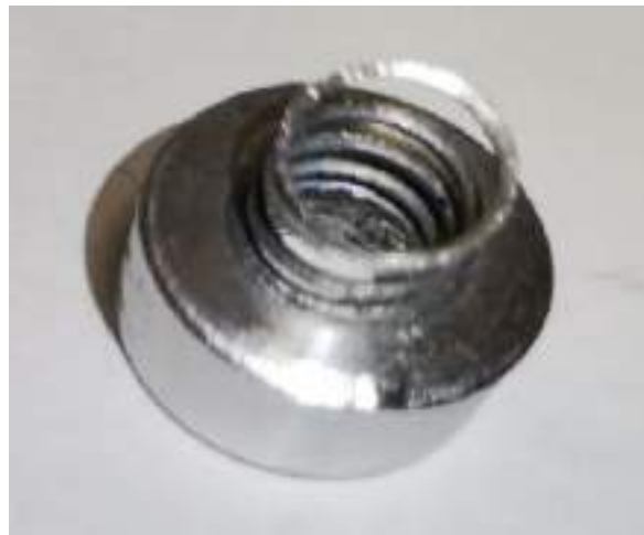
Рис.10. Разрушение алюминиевой гайки
