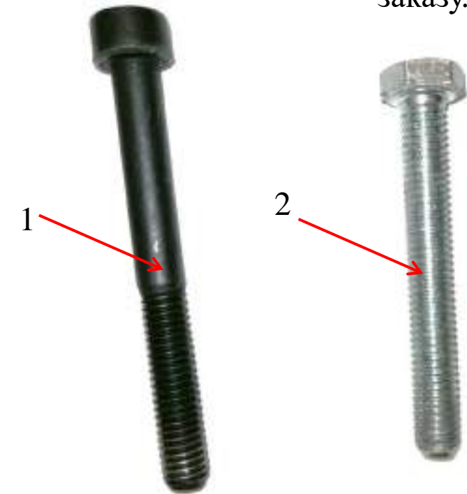
Рис.4. Болты классов прочности: 1 – 12,9; 2 – 10,9 (ГОСТ ISO 898-1-2014)
