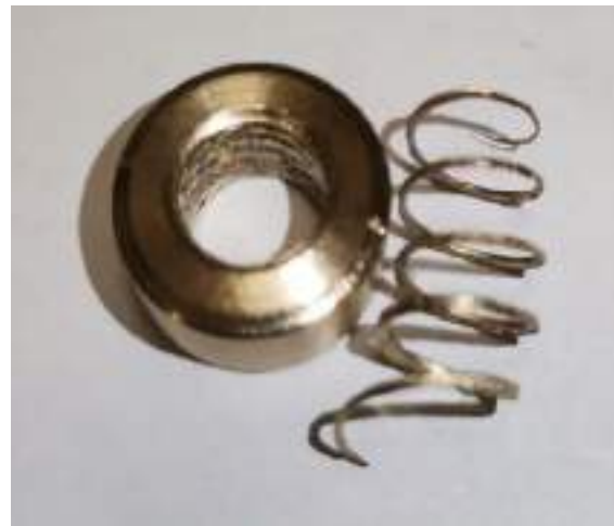
Рис.11. Разрушение гайки из бронзы железистой
