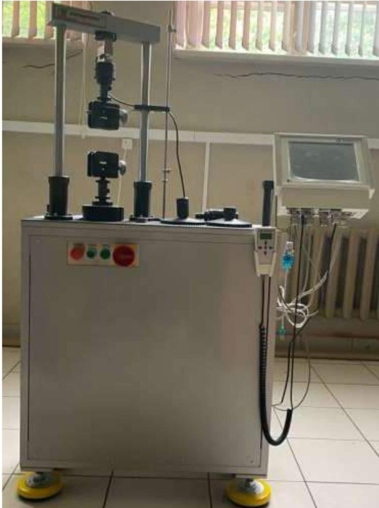
Рис. 3. Разрывная машина UTC
