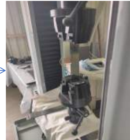
Рисунок 8. Образец, установленный в разрывную машину.
