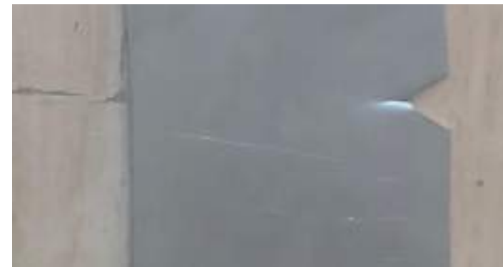
Рис. 15. Начало зарождения трещины на образце
