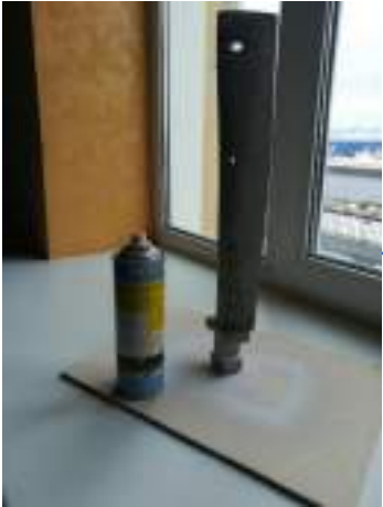
Рисунок 16. Лопатка, покрытая специальным составом
