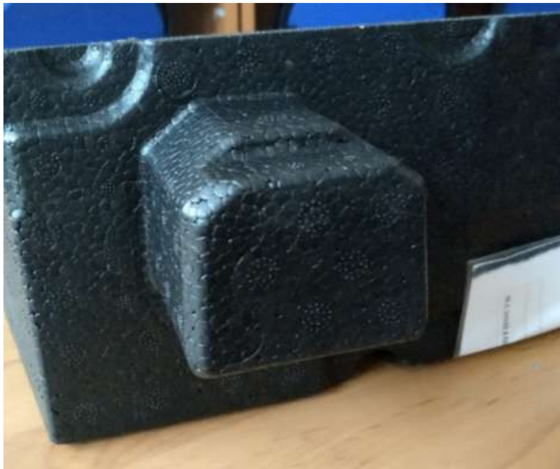
Рис. 5 – Энергопоглощающая деталь бампера автомобиля
