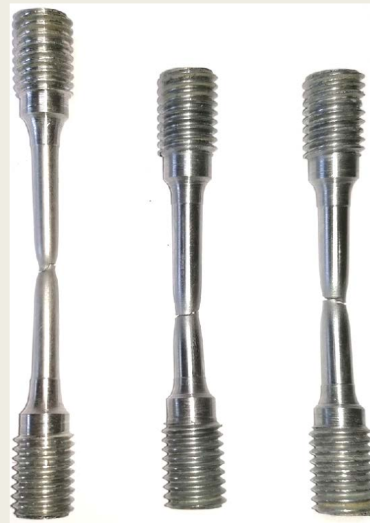
Рисунок 5. Образцы после испытания при нормальной температуре: а – сталь 12X18Н10Т; б – сталь 45
