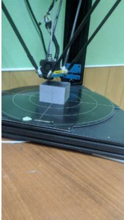
Рис.3. Процесс печати каркаса для крепления поляризатора
