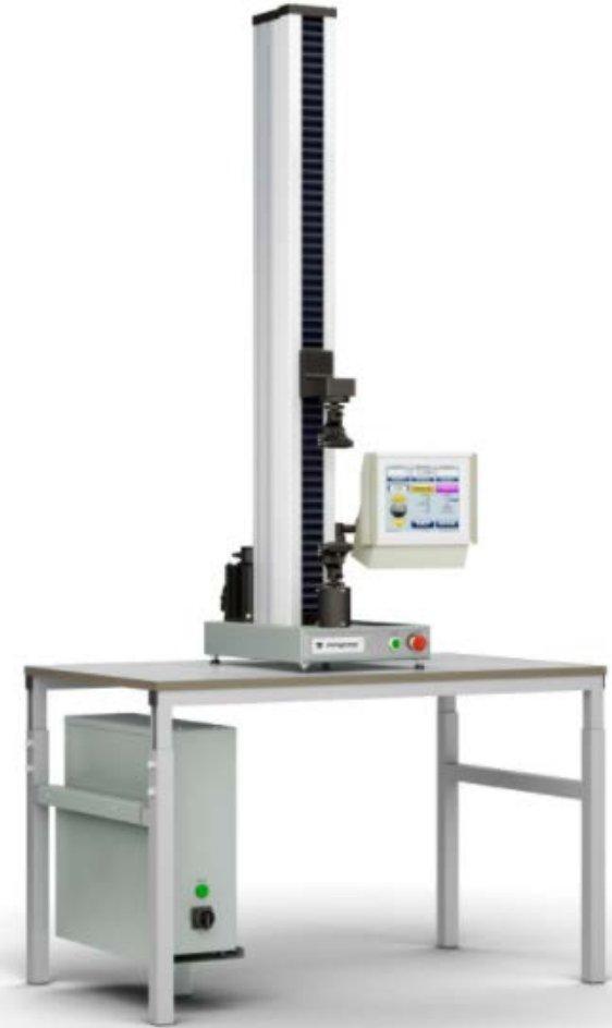
Рис. 4 Испытательная разрывная машина УТС-111.1-2,0-22
