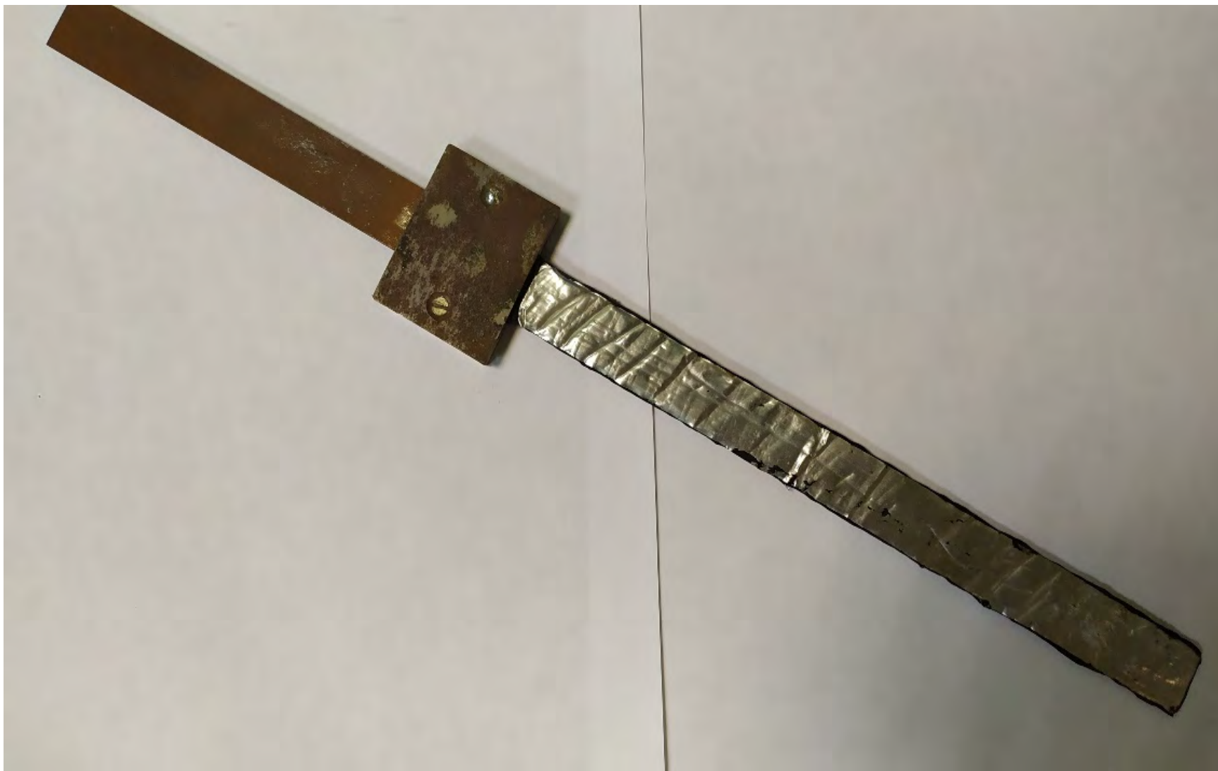
Рис. 6. Пластина, покрытая слоем шумоизоляционного полимера
