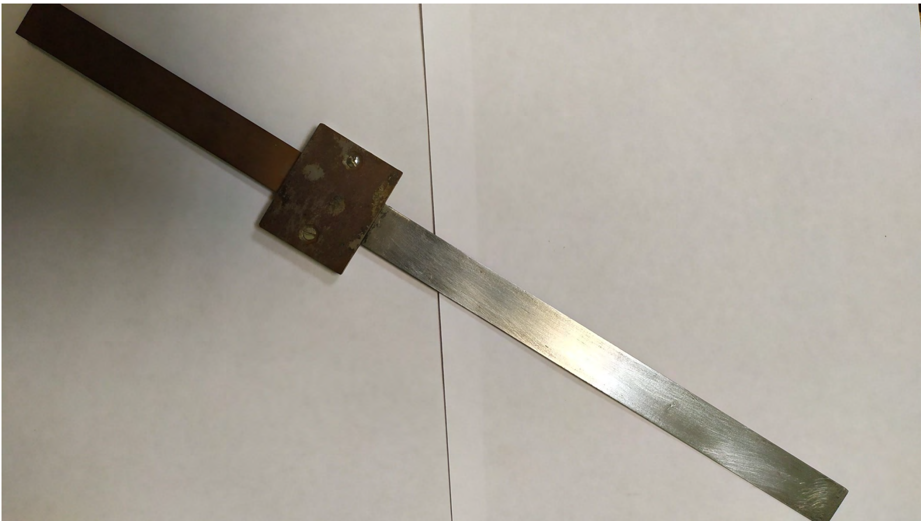
Рис. 5. Пластина без демпфирующего слоя
