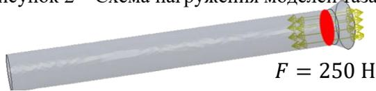
Рисунок 3 – Действие силы затяга винтов
